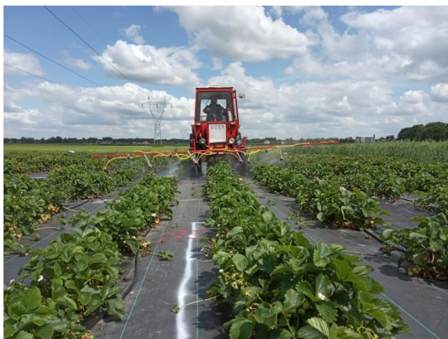
Fot. 2. Aplikacja biopreparatów przy pomocy opryskiwacza z belką typu Fragaria (fot. M. Nędzy)
