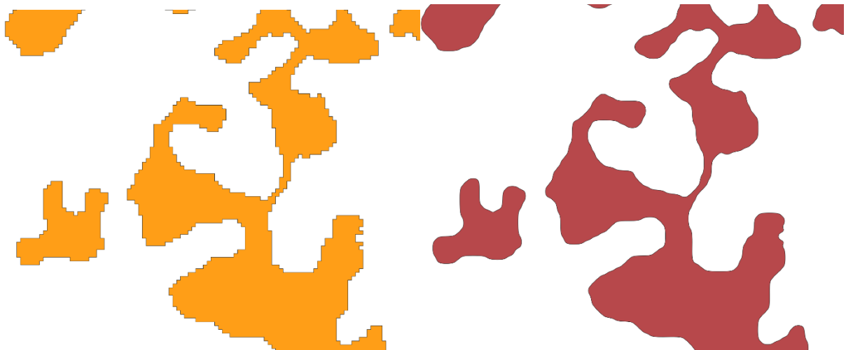
Rysunek 4. Przykład wygładzania warstwy wektorowej, po lewej po konwersji rastra na wektor, po prawej wygładzony wektor.
