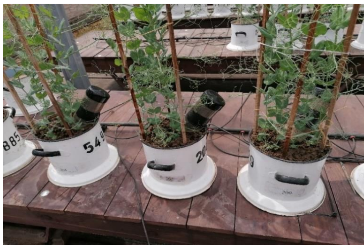
Rys.9. Tuby rizotronowe w doświadczeniu wazonowym z grochem
