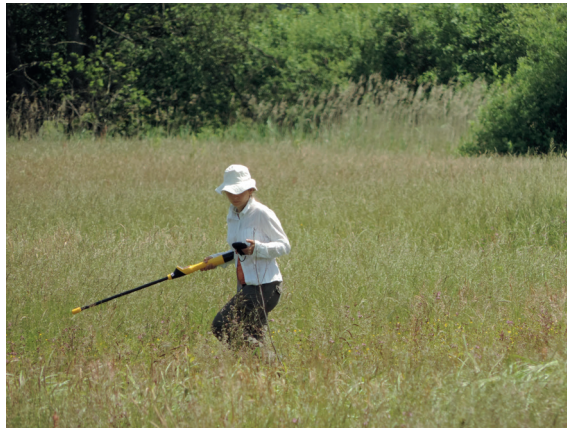
Ryc. 64. Lokalizowanie magnesów przy użyciu magnetometru oraz palmtopa z GPS
