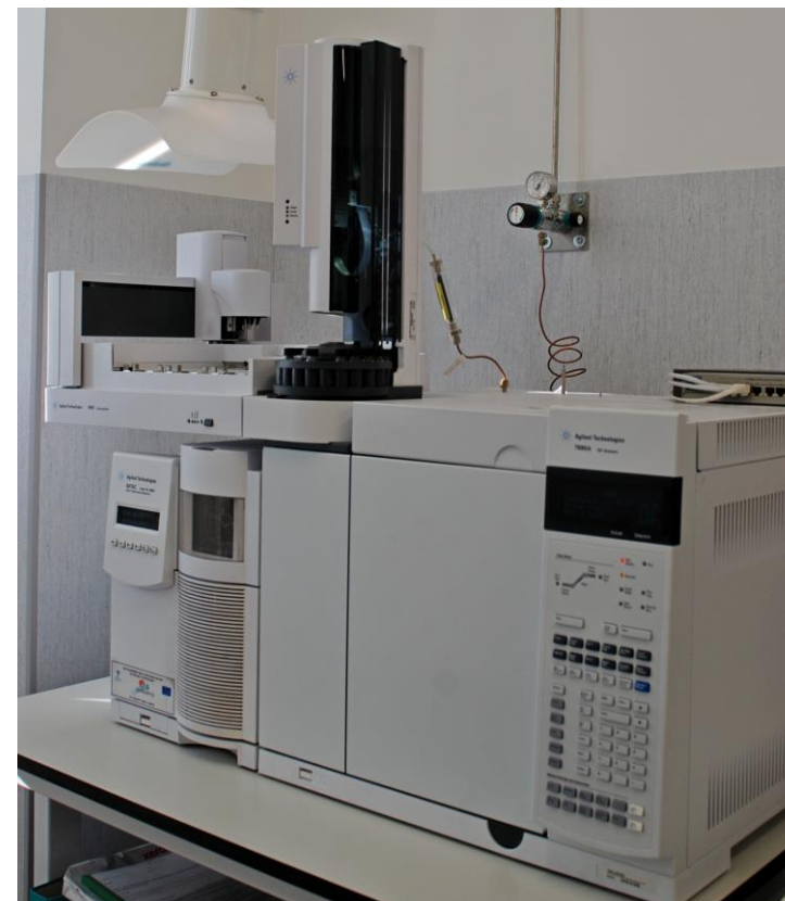
Chromatograf gazowy (Agilent 7890A) sprzężony z detektorem mas MS 5975C
