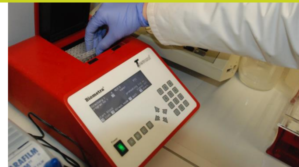
amplifikacja DNA w termocyklerze
