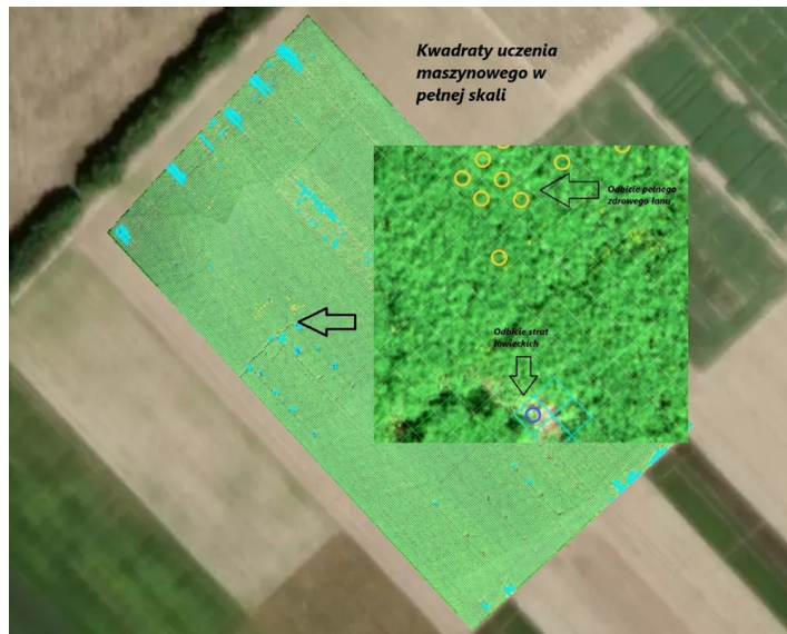
Rys. 23. Pole rzepaku z częściowo występującymi uszkodzeniami mechanicznymi wskazanymi przez uczenie maszynowe na obrazie RGB
