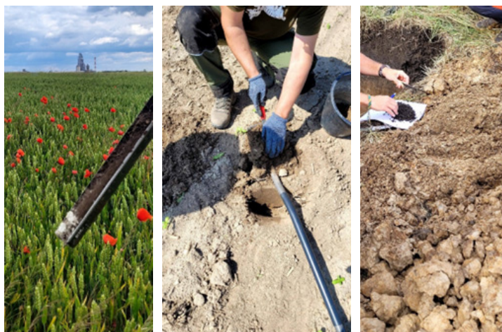
Fot. 7. Pobór próbek glebowych do analiz z upraw położonych w strefie oddziaływania przemysłowego (Fot. M. Łysiak)
