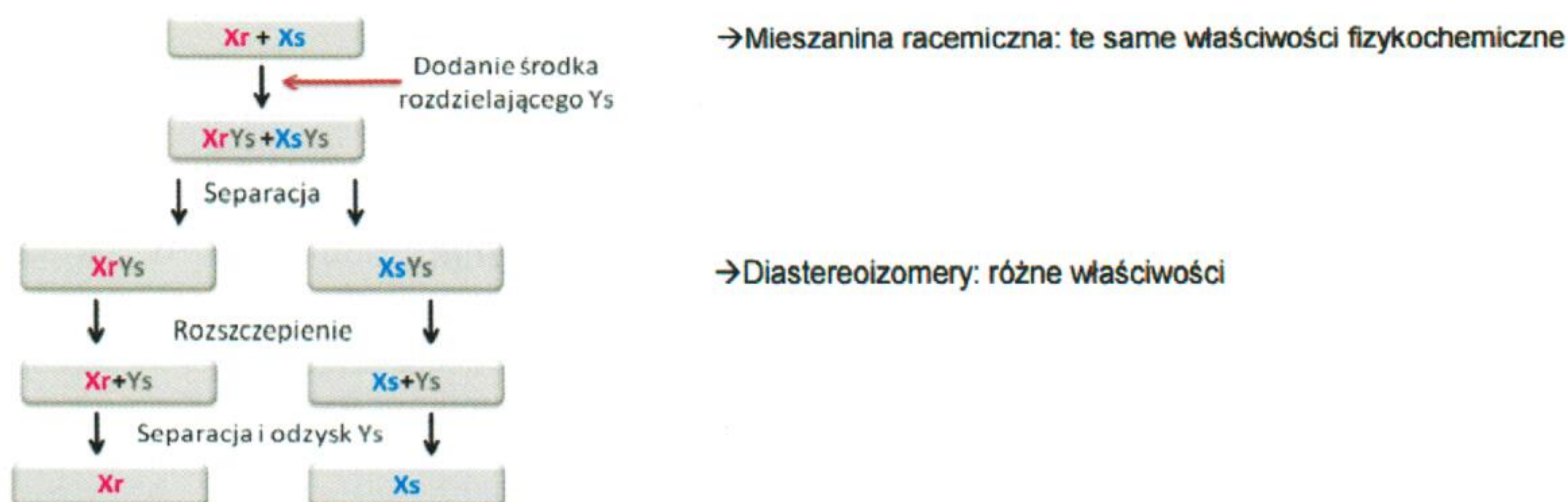
Rys.5. Schemat formowania soli diastereoizomerycznych przy użyciu chiralnego środka rozdzielającego.
