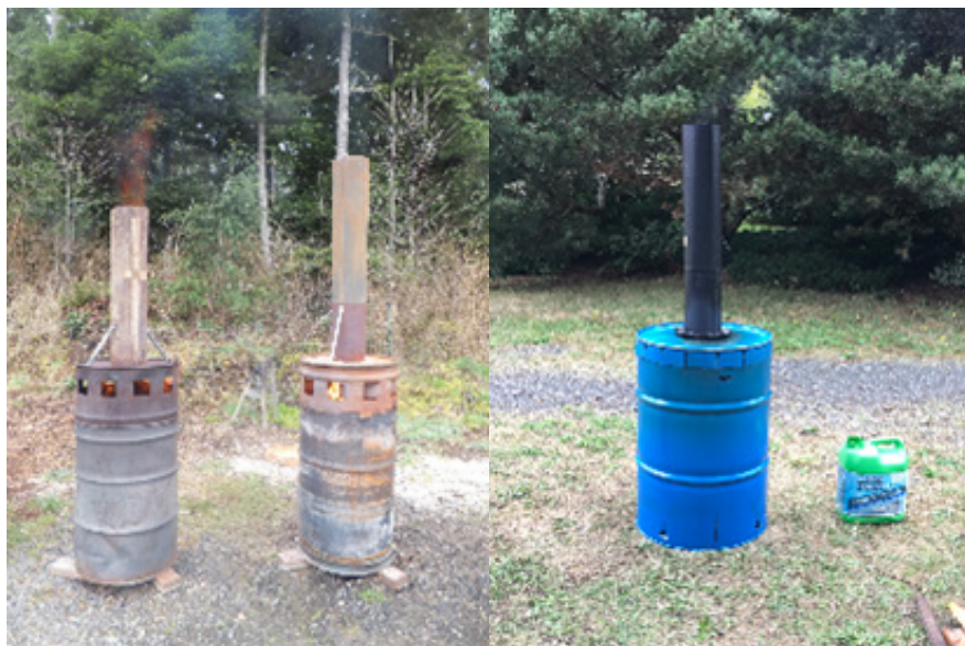
Rys. 8. Przykładowe piece do pozyskiwania węgla z biomasy ( https://tinkersblessing.com )
