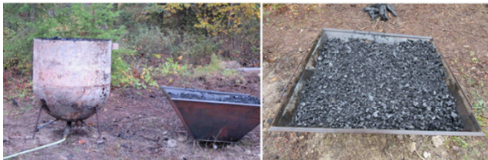
Rys. 4. Węgiel wyprodukowany w metalowych kotłach typu „Kon-Tiki” ( https://www.thebiocharrevolution.com/ )
