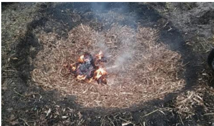
Rys. 1. Piroliza zrębek drzewnych w zagłębieniu ziemnym; Etap I – początek procesu (fot. P. Radzikowski)
